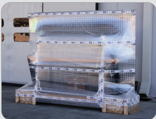
Palet de exportación con sistema antivuelco
